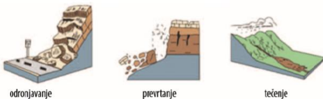
Slika 9: Prikaz osnovnih tipova klizanja prema mehanizmu kretanja
